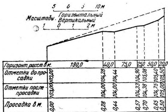
Рис. 130. Профиль просадки пульповода.
