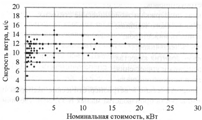
Рис. 4.2. Сравнение номинальной мощности и выбранной производителями номинальной скорости ветра
