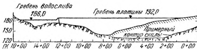
Рис. 39. Разрез по оси плотины Найтвил.
