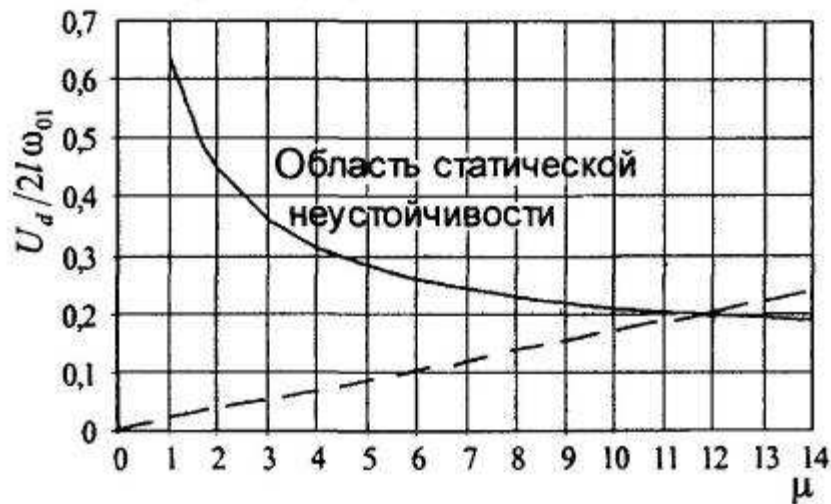
Рис. 3.2. Зависимость безразмерной скорости дивергенции U_d от безразмерного комплекса \mu = \frac{\rho_0 2l}{\rho_m h} ( \rho_0 - плотность воды; \rho_m - плотность металла; h - толщина; 2l - длина элемента облицовки).
